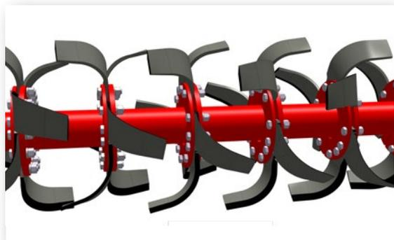
Il rotore a Zappe può montare 2 tipi di zappe, a «C» e «L», in grado di massimizzare l'affinamento del terreno e l'incorporamento del residuo colturale.
