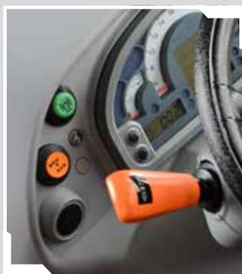
Inversore idraulico con Stop&Go.
