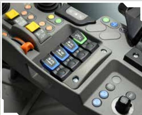
Distributori idraulici a controllo elettronico.
