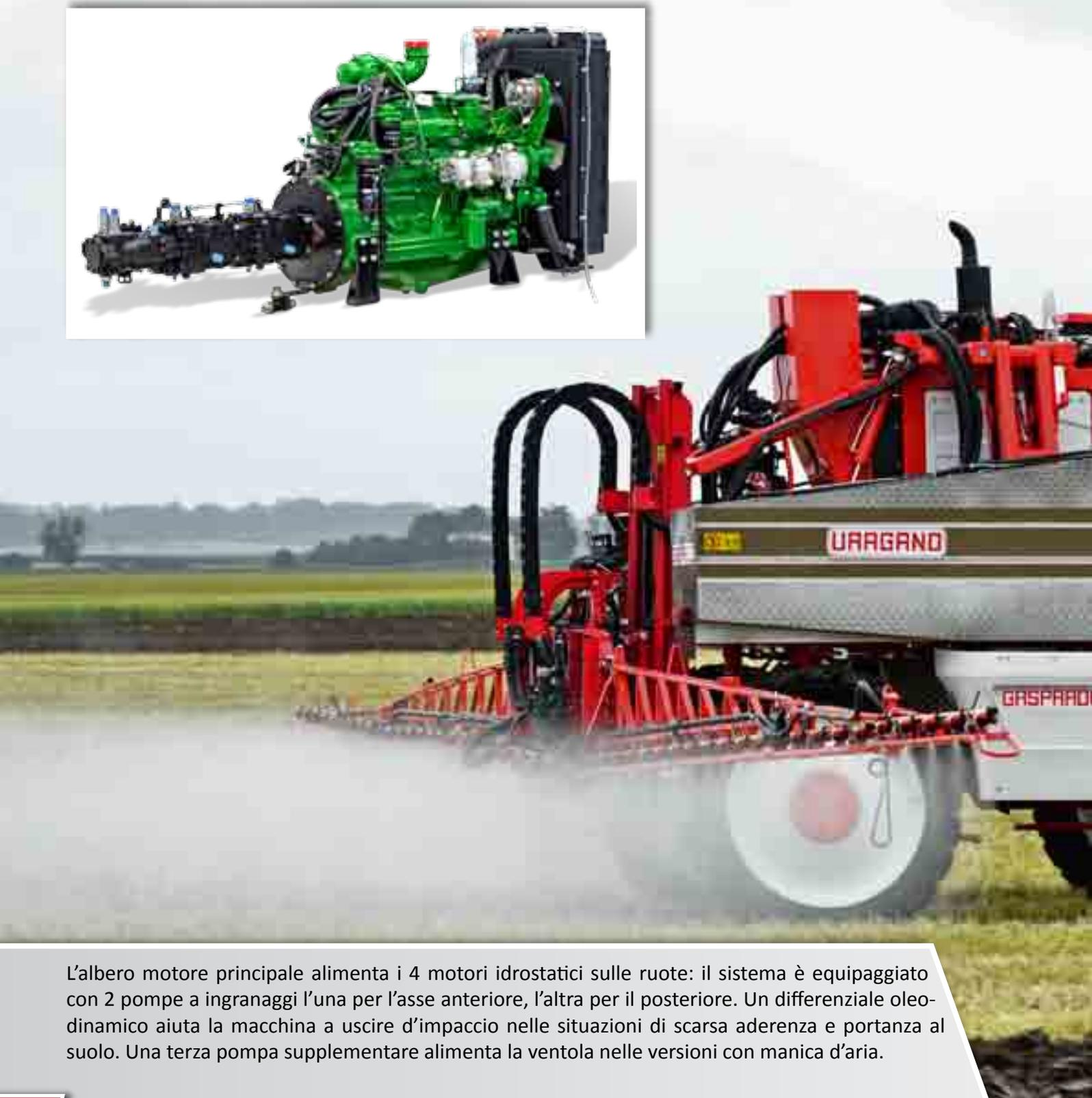
L'albero motore principale alimenta i 4 motori idrostatici sulle ruote: il sistema è equipaggiato con 2 pompe a ingranaggi l'una per l'asse anteriore, l'altra per il posteriore. Un differenziale oleodinamico aiuta la macchina a uscire d'impaccio nelle situazioni di scarsa aderenza e portanza al suolo. Una terza pompa supplementare alimenta la ventola nelle versioni con manica d'aria.
