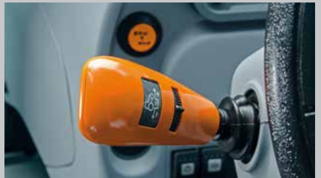
Leva PowerShuttle con interruttore di attivazione SenseClutch e Stop&Go.
