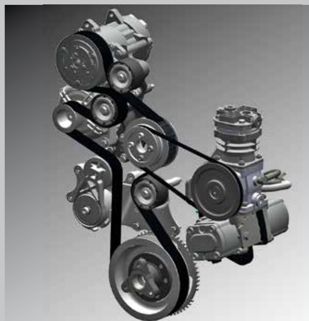
La cinghia di trasmissione a regolazione automatica è una cinghia trapezoidale esente da manutenzione con tendicinghia automatico. Nessun rischio di slittamento della cinghia e quindi di surriscaldamento.
