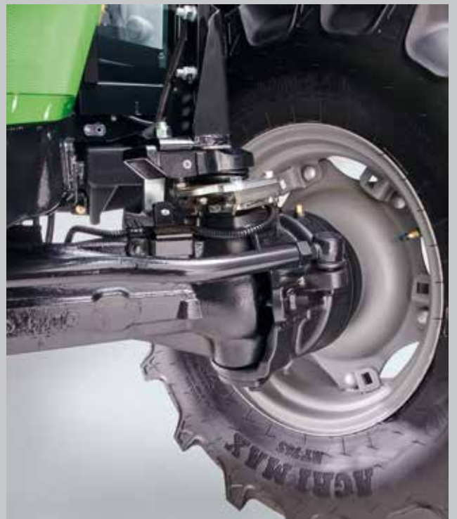
Impianto frenante sulle quattro ruote con dischi freni in bagno d'olio.
