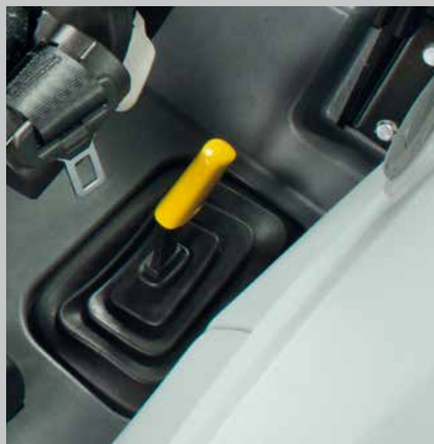
Una soluzione semplice – comandi meccanici della PTO sui modelli Ecoline.
