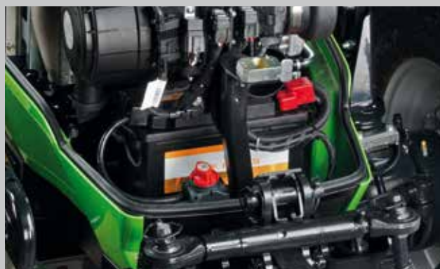
Lo staccabatteria è situato sul lato anteriore del trattore.
