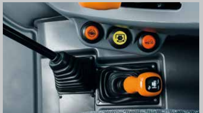
Comandi elettroidraulici per innesto PTO, DT e bloccaggio del differenziale (LS e GS).
