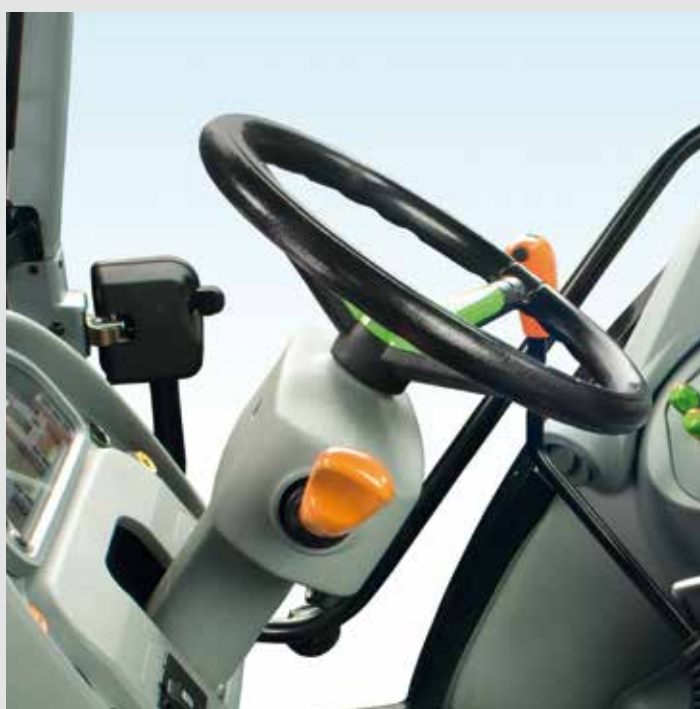
Il volante telescopico, con inclinazione regolabile può essere liberamente adattato al singolo operatore.
