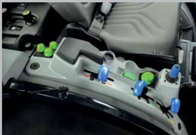
Comandi idraulici e del sollevatore idraulico posteriore. Disposti in modo ordinato sulla destra del sedile.
