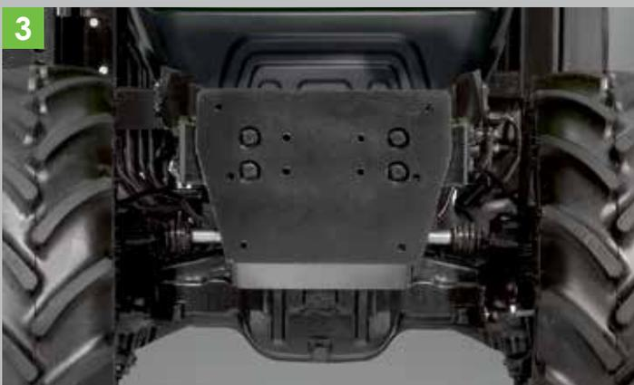
3 Piastra di attacco anteriore per il fissaggio rapido e sicuro delle attrezzature speciali.
