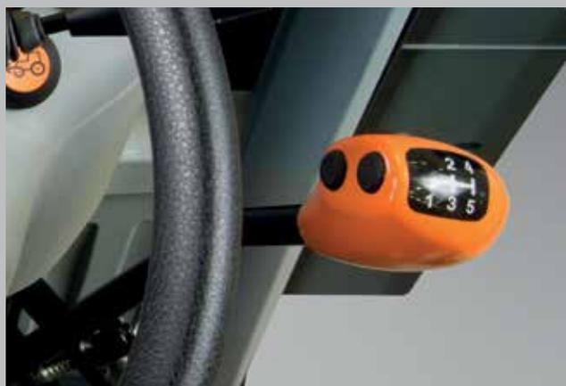
POWERSHIFT. Cambiare marcia con la pressione di un pulsante e senza azionare la frizione.
