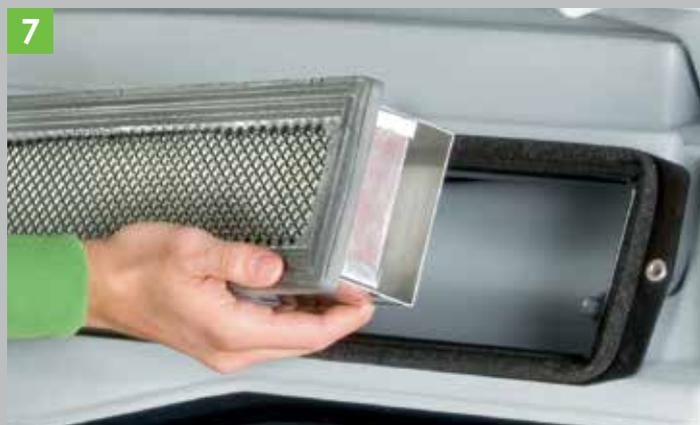
7 Il filtro aria in cabina protegge da polvere e prodotti chimici. Aria sempre pulita in cabina.
