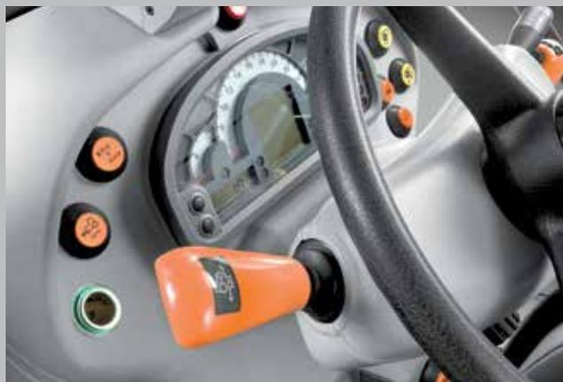
Powershuttle. Per invertire il senso di marcia con un semplice tocco.
