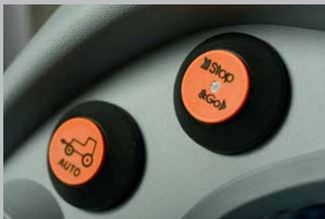
STOP&GO. Per avviare e arrestare il veicolo con la massima comodità senza usare il pedale della frizione.
