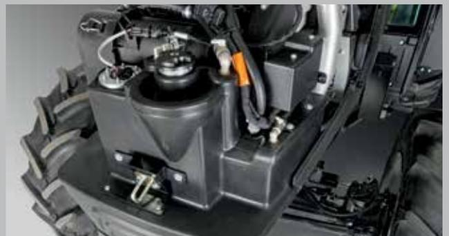
Il rifornimento del serbatoio carburante, integrato nel blocco ponte anteriore, può essere effettuato con il cofano chiuso, mentre un serbatoio aggiuntivo è previsto sotto il telaio.
