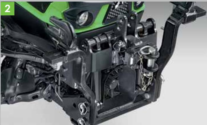
2 Idraulica anteriore e presa di forza anteriore per efficienti combinazioni di attrezzature.
