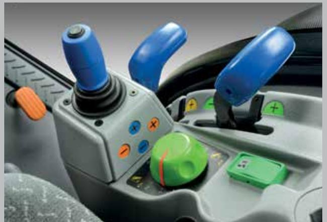
Comandi per sollevatore idraulico posteriore e attrezzature di lavoro idrauliche: raggruppati e facilmente accessibili.
