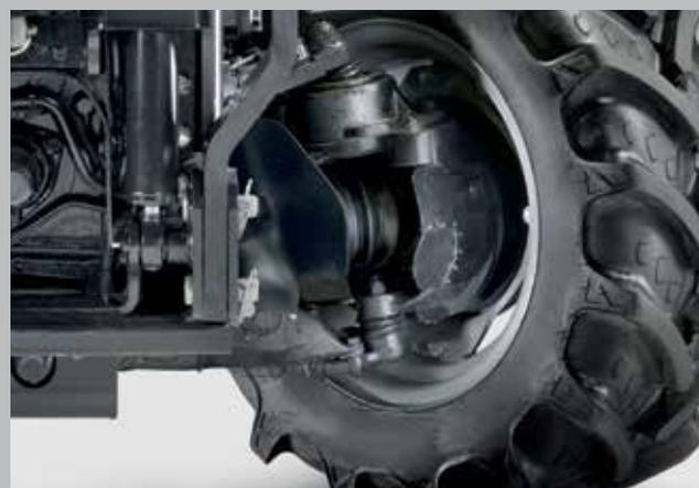
Impianto frenante sulle 4 ruote e valvole freni separate. Sicurezza in ogni situazione. Agile e intelligente per manovre rapide.
