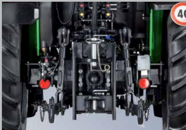
Il sollevatore posteriore: con capacità di sollevamento fino a 4.525 kg, per un controllo di massima precisione. Quattro velocità di serie per la presa di forza posteriore.
