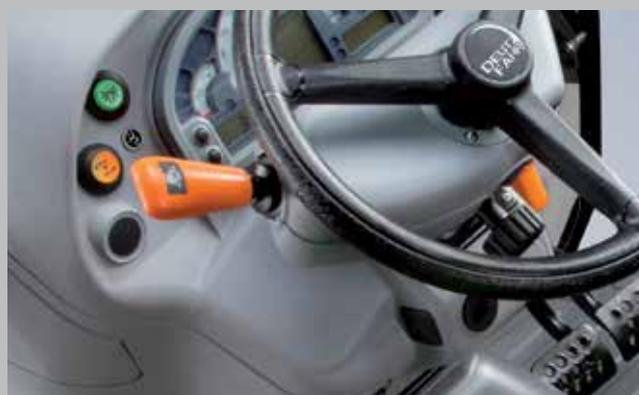
Sistema di inversione elettroidraulico: per cambiare il senso di marcia senza interruzione di coppia.
