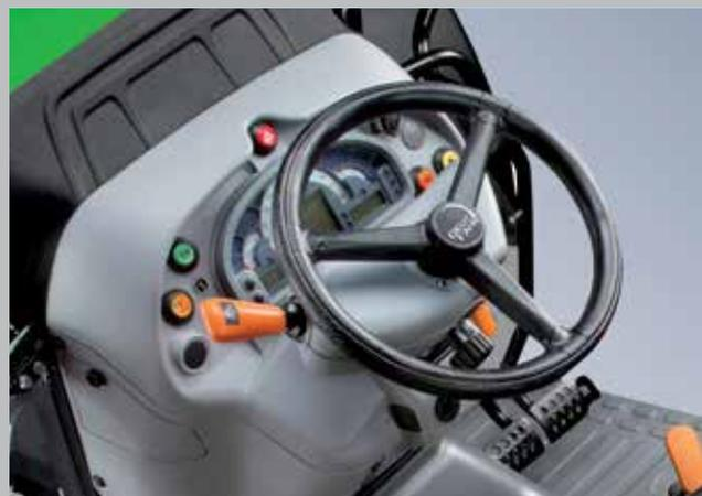
L'innovativo sistema di sterzata rapida SDD dimezza il numero di giri del volante necessari per coprire l'intero angolo di sterzata.
