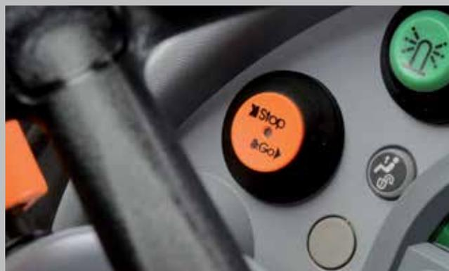
Sistema stop&Go: arresti e partenze con l'impiego del solo pedale del freno.
