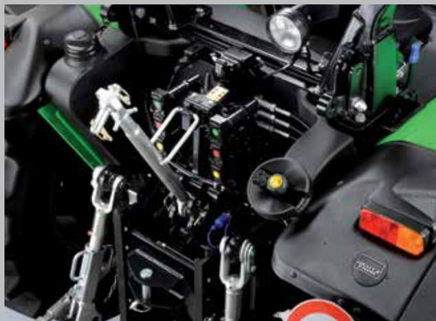
La pompa idraulica da 55 l/min alimenta fino a 3 distributori idraulici posteriori.
