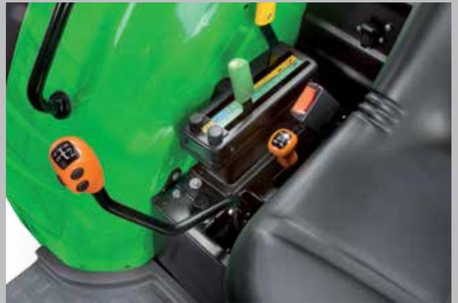
A destra dell'operatore: leva cambio, sollevatore posteriore e unità di comando idrauliche disposte in modo ergonomico.
