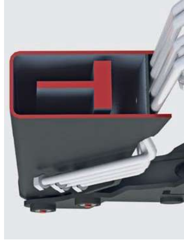
Sezione trasversale di un braccio del caricatore - Il tirante del parallelismo si trova al suo interno. Al di sotto sono posizionate le linee idrauliche.
