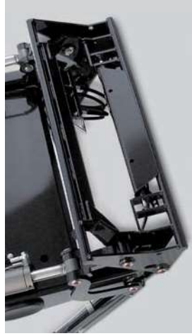
L'attrezzo terminale si blocca tramite un pulsante, — inoltre è possibile sostituire sostituirlo senza lasciare la cabina di guida — con HYDRO LOCK
