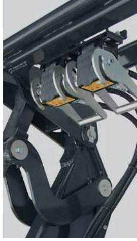
Tool-Fix Accoppiamento rapido a due vie per 3° e 4° circuito idraulico
