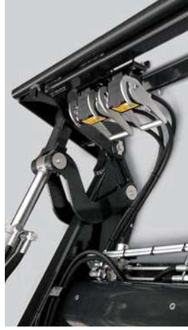
Sistema rapido di accoppiamento delle linee idrauliche; praticamente un Hydro Fix per gli attrezzi terminali
