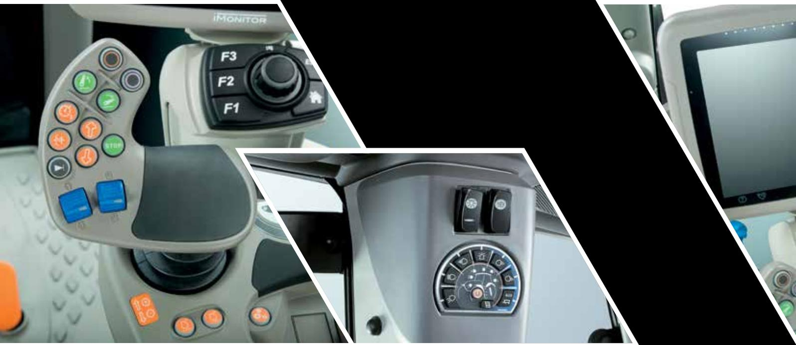
Il livello di automazione dei Lamborghini Spark 155-215, già praticamente al top, può essere ulteriormente elevato con allestimenti opzionali che comprendono gli ausili satellitari alla guida automatica Agrosky, disponibili in varie versioni fino ad un'accuratezza di  $\pm 2$  cm. Inoltre, la compatibilità completa agli standard ISOBUS 11783 prevede un'interfaccia ottimizzata per un'operatività rapida ed immediata con le
