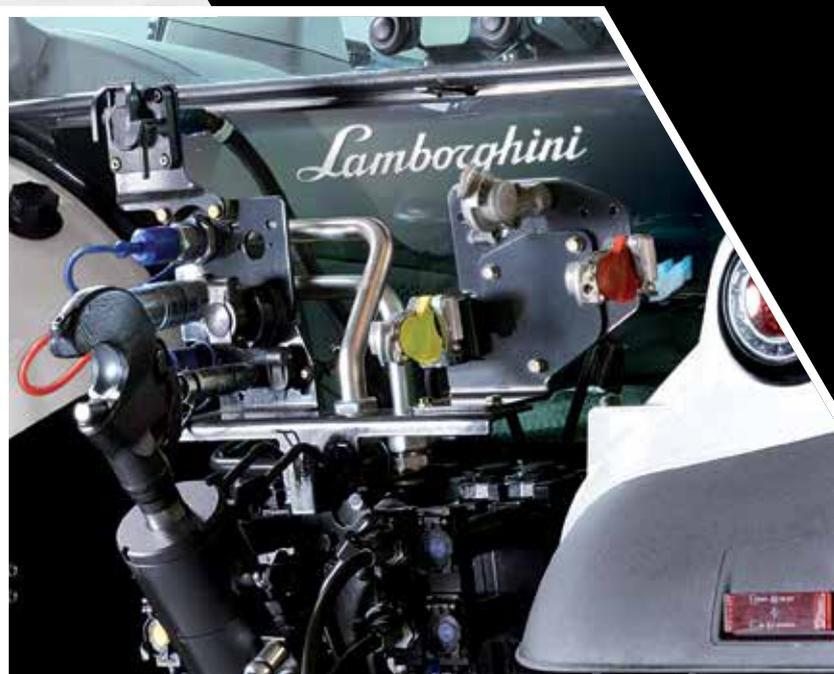
principale: sui modelli 155, 165 e 175 con trasmissione Powershift o RCshift è installato di serie un impianto a centro aperto con pompa da 84 l/min, ma a richiesta si può avere una pompa Load Sensing da 120 o 160 l/min. Viceversa, sui modelli 185, 205 e 215 con trasmissione Powershift o RCshift e su tutti i modelli VRT l'impianto Load Sensing con pompa da 120 l/min è di serie, e in alternativa è disponibile quella da 160 l/min (o addirittura da 170 l/min per i modelli 155, 165, 175 e 185 VRT).
