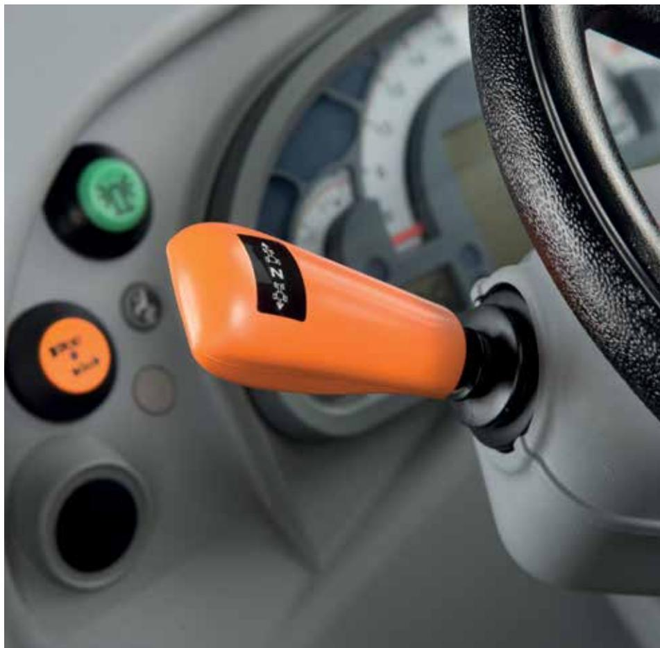
modulato, facendo ripartire il trattore nella direzione di marcia inserita. Se è presente la funzione Hi-Lo, tramite i comandi a pulsante posti sulla leva del cambio, è possibile passare in modo rapido e fluido dalla velocità normale a quella ridotta (e viceversa) anche sotto-carico, senza intervenire sulla frizione principale.
