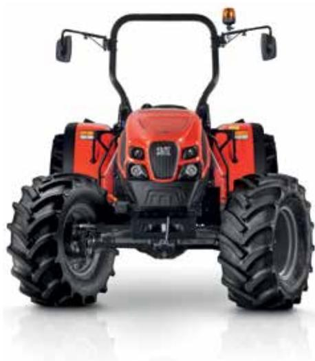
**L**asse anteriore incorpora i freni a dischi multipli a bagno d'olio e offre un elevato carico massimo ammissibile di 2.900 kg.
