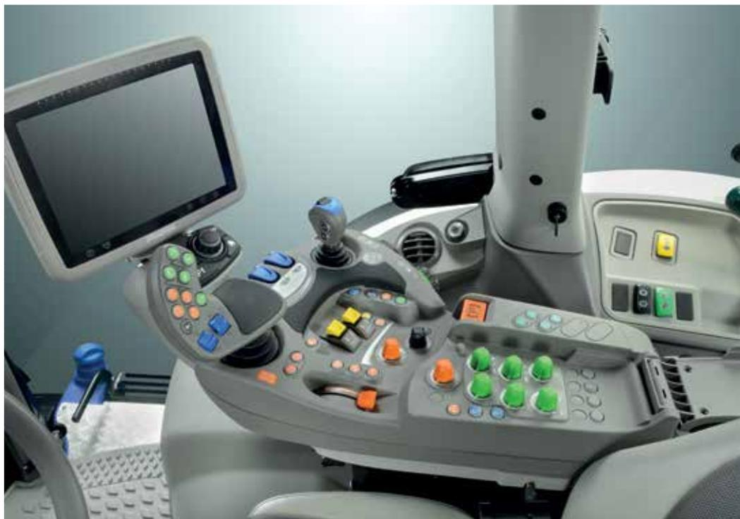
La funzione Trailer Stretch aumenta la sicurezza di guida su terreni accidentati, mentre il PowerZero consente di fermare temporaneamente il trattore (anche su terreni in pendenza e con il rimorchio) semplicemente rilasciando il pedale dell'acceleratore, quindi senza dover agire sui pedali dei freni, sulla leva del PowerShuttle o sul comando della frizione.
