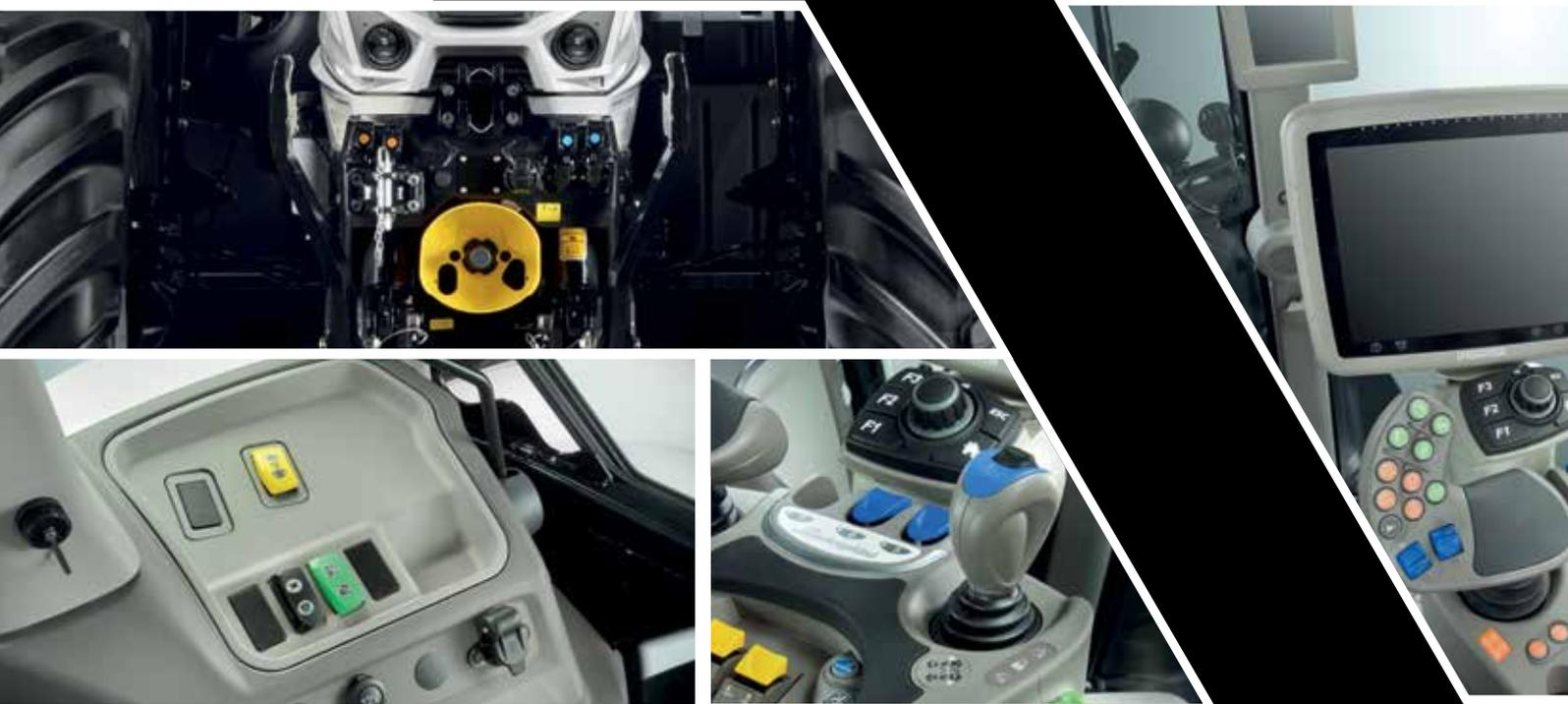
Sui nuovi Mach VRT sono previsti fino a 5 distributori idraulici posteriori e due anteriori, tutti comandati elettronicamente, anche con pilotaggio proporzionale. In opzione c'è il sollevatore anteriore a posizione controllata, con capacità massima di sollevamento di 5.480 kg.
