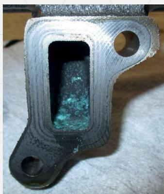
Il silicato contenuto nei refrigeranti, quando viene a contatto con elementi elettronegativi quali zinco e fluoro, precipita nella soluzione acquosa presente nel motore, creando uno strato di deposito sulla testa.
