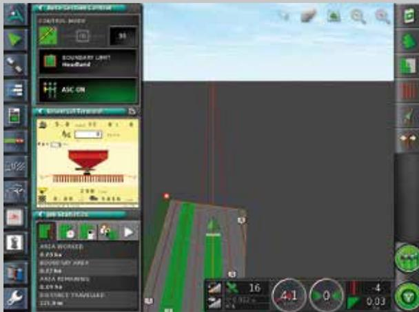
L'abbinamento di ISOBUS e AGROSKY di DEUTZ-FAHR consente di comandare automaticamente le sezioni separate per la distribuzione di sementi, fertilizzanti o pesticidi.
