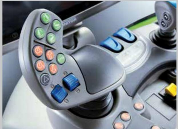
La leva di guida MaxCom è l'interfaccia operatore per l'attrezzatura ISOBUS.
