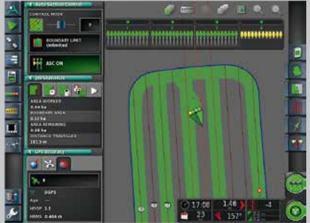
Parti delle sezioni vengono disinserite automaticamente, ma possono anche essere disattivate manualmente dal display virtuale.
