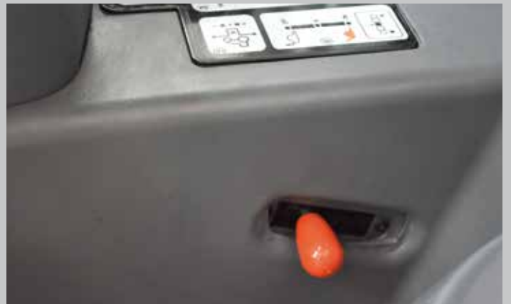
Trasmissione con super riduttori: quattro marce aggiuntive per lavorare a velocità ultraridotte.
