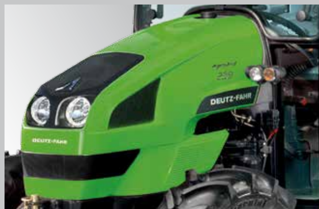
Il materiale utilizzato per il cofano è il Telene®, una speciale resina termoindurente.
