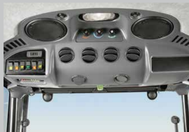
I comandi del riscaldamento e della climatizzazione sono opportunamente installati nel tetto della cabina.
