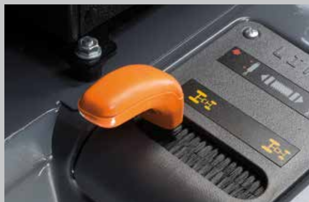
La doppia trazione può essere selezionata manualmente per migliorare in modo notevole la trazione e ridurre il compattamento del terreno.
