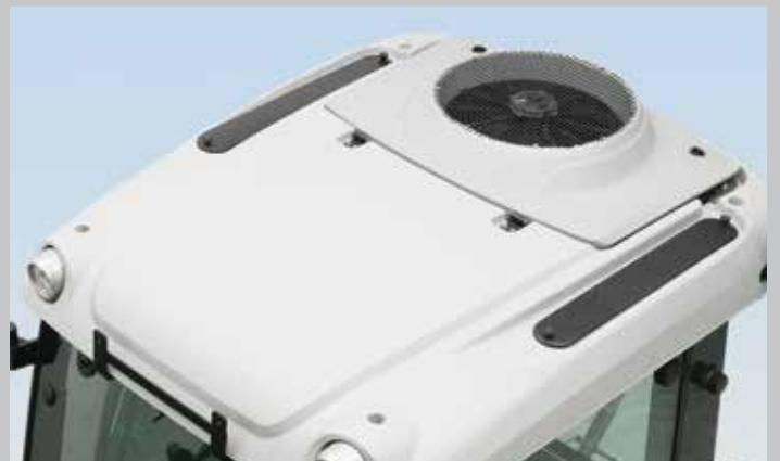
Impianto di condizionamento: Disponibile su richiesta.
