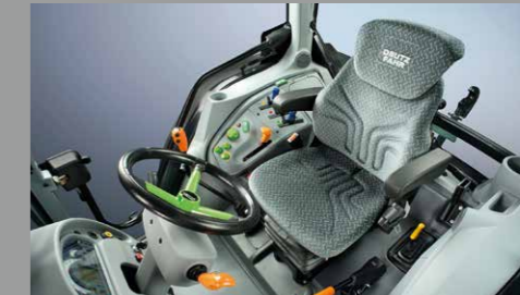
Spaziosa cabina a quattro montanti, vetro anteriore apribile, tetto alta visibilità.
