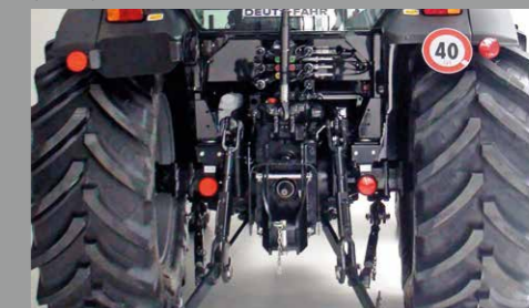
Il sollevatore posteriore della serie 5D, con martinetti supplementari aggiuntivi, solleva fino a 3.600 kg e pertanto può gestire tutte le attrezzature tipiche di questa classe di potenza.
