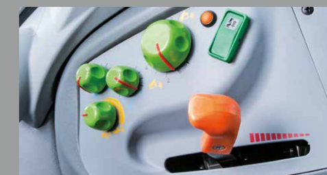
Comando elettronico del sollevatore (EHR - Electronic Hitch Regulator) e una memoria elettronica della velocità del motore per richiamare le velocità durante i lavori di routine.
