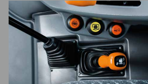
Attivazione / disattivazione elettro-idraulica di: Presa di forza, quattro ruote motrici e bloccaggio dei differenziali (LS/GS).
