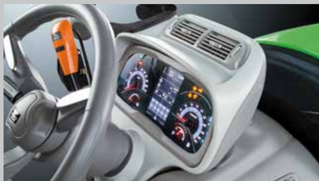
Cruscotto allo stato dell'arte con nuovo InfoCentre pro : Display LCD a colori da 5" ad alta risoluzione personalizzabile per informazioni giudicate importanti per quella lavorazione.
