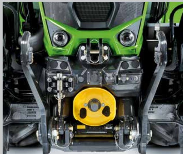
Nuovo controllo della posizione del sollevatore anteriore (modelli TTV) con capacità di sollevamento massima di 5.480 kg.
