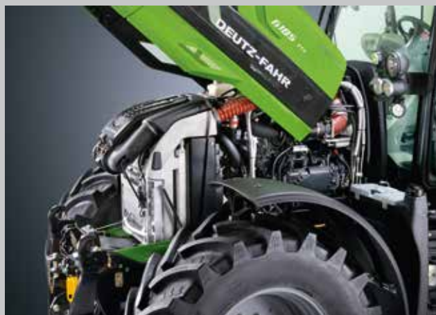
Sistema di raffreddamento estremamente efficiente e compatto con intercooler, radiatori motore, olio cambio e carburante e condensatore aria-condizionata.
