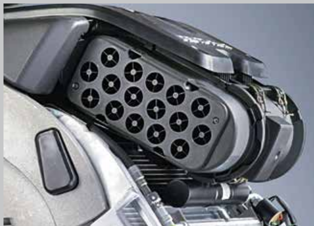
Sistema di depurazione preliminare del filtro dell'aria aspirata: tubi ciclonici a spirale e un tubo flessibile dell'aspiratore eliminano il 95% della polvere prima che penetri nel filtro primario.
