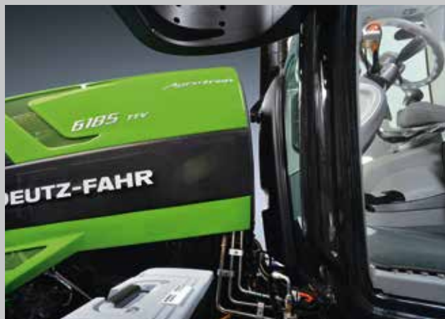
Cabina e cofano motore sono separati fra loro per ridurre notevolmente la trasmissione di rumori e vibrazioni garantendo così il massimo comfort.
