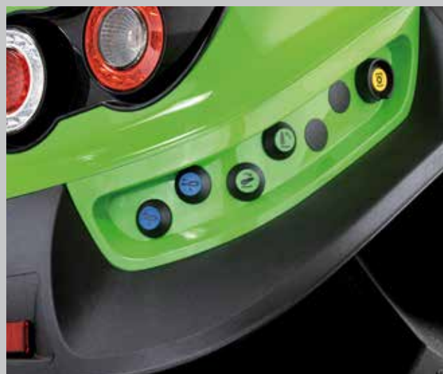
I comandi remoti esterni del sollevatore idraulico posteriore e della PTO possono essere facilmente comandati da entrambi i lati.
