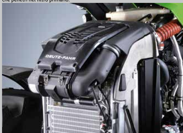
Filtro aria con tecnologia PowerCore: portata d'aria del 20% superiore a quella degli analoghi filtri standard.
