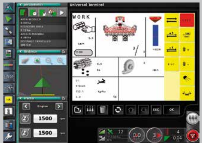
Le funzioni TIM ready (Tractors Implement Management) sono in grado di soddisfare automaticamente le richieste delle attrezzature.
