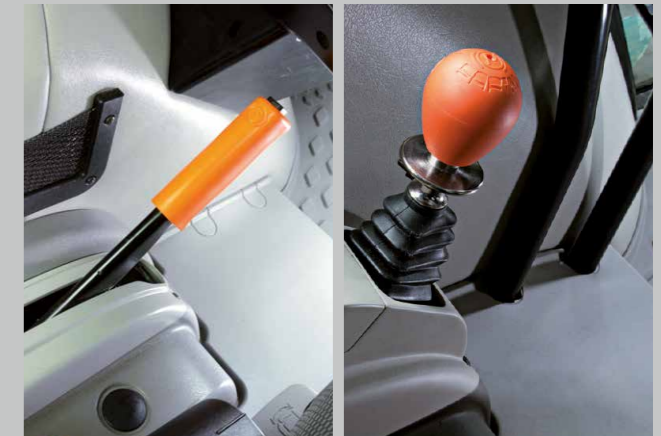
Freno di stazionamento meccanico o idraulico. A te la scelta.
