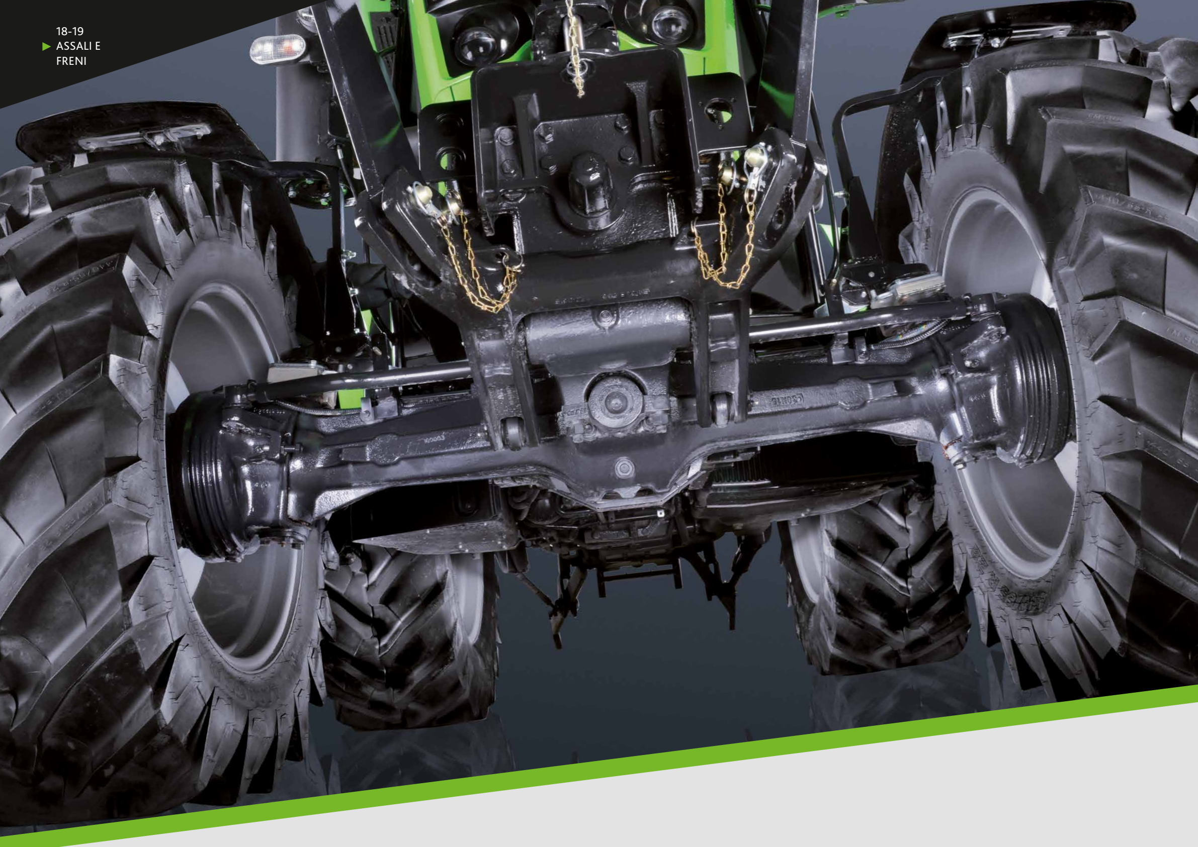
L'esclusivo concetto di sicurezza targato DEUTZ-FAHR. Freni a disco separati raffreddati a olio sulle ruote anteriori.
