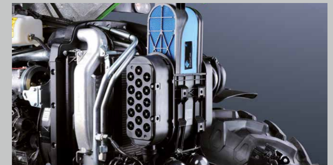
Il filtro dell'aria PowerCore supporta l'efficienza del motore ...
