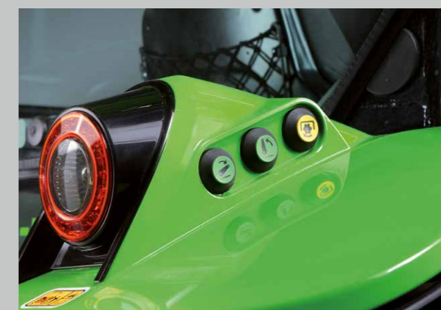
Azionamento esterno di PDF e sollevatore per l'agevole accoppiamento delle attrezzature e per l'azionamento esterno della PDF.
