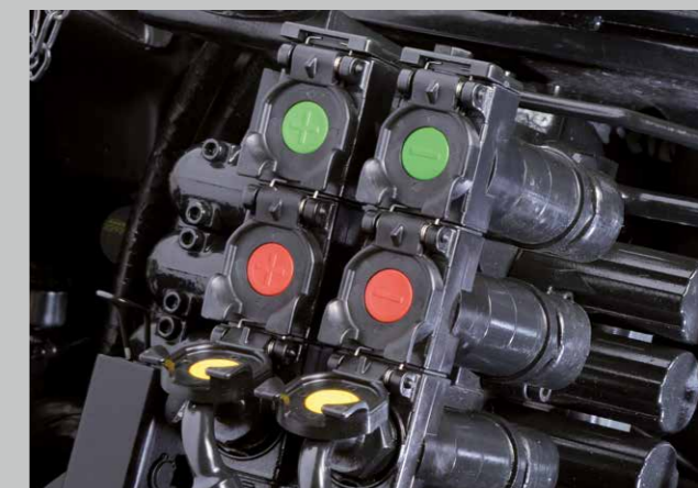
I distributori idraulici "High-Flow". maggiore potenza dove è necessario.
