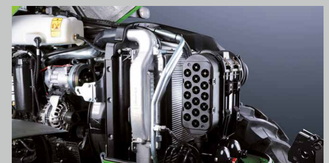
... e lo stesso si può dire dell'impianto di raffreddamento con ventola viscostatica opzionale, facile da pulire.
