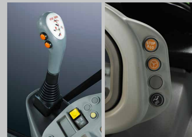
Il joystick del caricatore frontale con i pulsanti Powershift, Stop&Go, sistema di sterzata rapida SDD e tutti...
