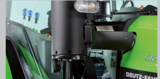
Tecnologia di depurazione gas di scarico all'avanguardia come il sistema SCR (riduzione catalitica selettiva) o...
