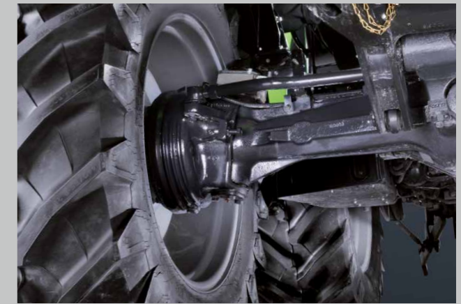
L'esclusivo concetto di sicurezza targato DEUTZ-FAHR. Freni a disco separati raffreddati a olio sulle ruote anteriori.
