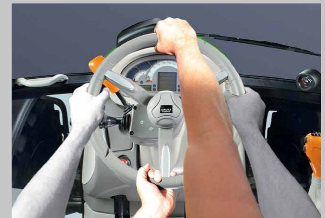
Il sistema di sterzata rapida SDD. Rotazioni del volante dimezzate, per un doppio angolo di sterzata.
