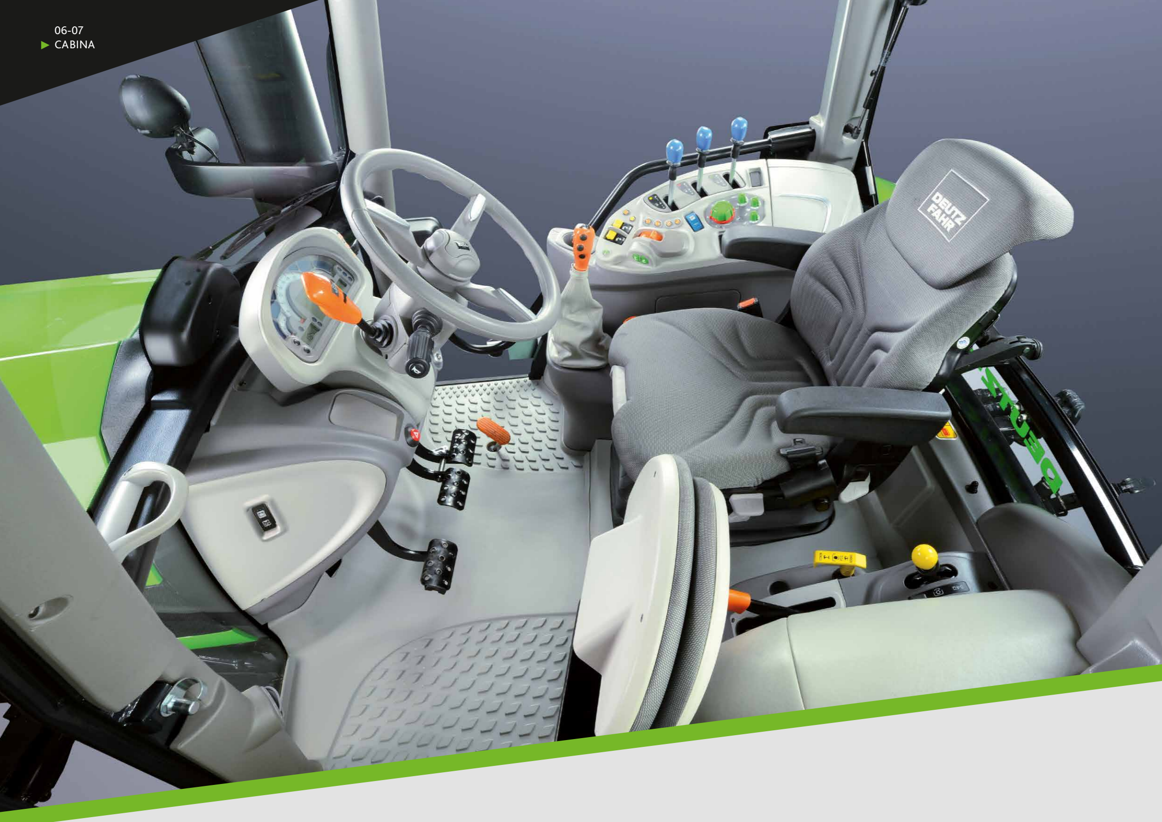
Riduzione delle vibrazioni in cabina fino al 40% grazie al supporto degli Hydro-Silent block.
