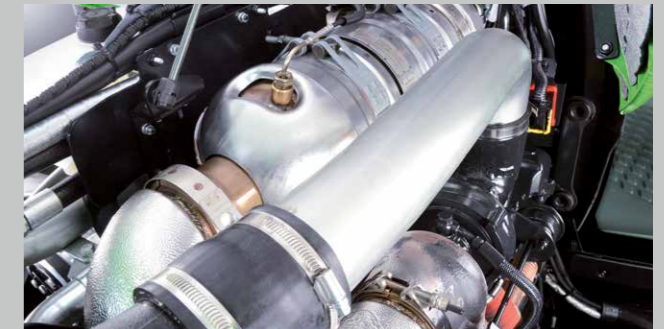
... il catalizzatore DOC (catalizzatore ossidante diesel) assicurano livelli di emissione minimi.
