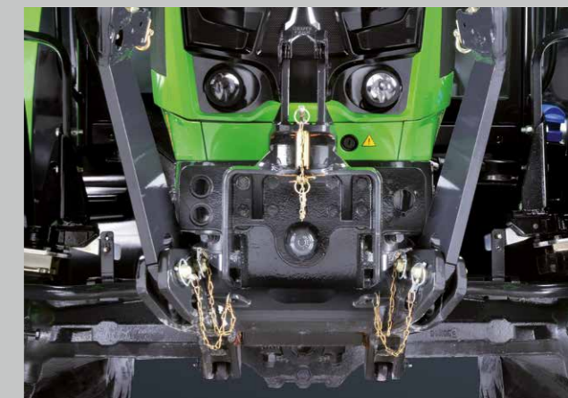
Area attrezzature anteriori. Capacità di sollevamento di 2100 kg e PDF 1000.
