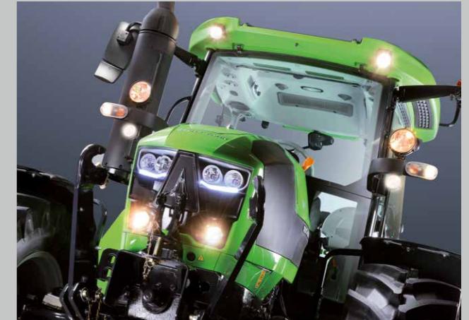
Il pacchetto luci. Per l'illuminazione della zona circostante in condizioni di scarsa visibilità. Otto fari di lavoro sul tetto e sui montanti laterali. Due fari di lavoro e due luci a LED sul cofano.
