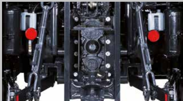
PTO posteriore con un massimo di quattro velocità, funzione PTO automatica. PTO anteriore opzionale da 1.000 giri/min.
