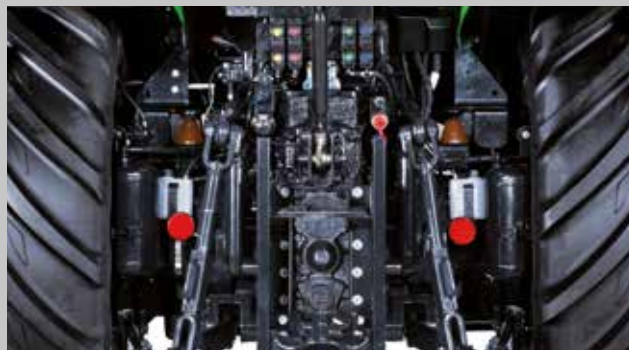
Caratteristiche impressionanti: sollevatore elettronico con attacco a tre punti di categoria 3, con capacità di sollevamento massima di 7.000 kg.
