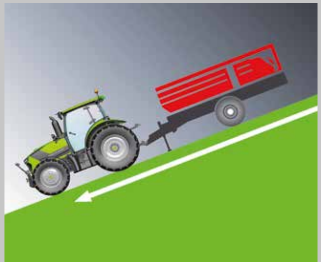
Un freno idraulico o pneumatico del rimorchio assicura una guida sicura anche con carichi pesanti.
