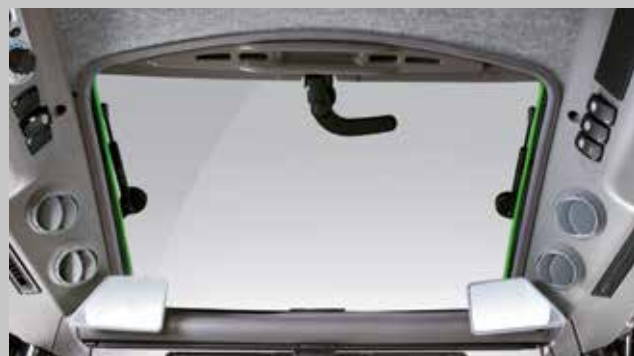
Possibilità di scelta tra quattro diverse tipologie di tettuccio: un tettuccio trasparente, con o senza FOPS e un tettuccio opaco, con o senza FOPS.
