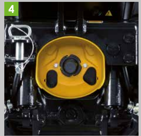
4 Per una versatilità ancora superiore: PTO anteriore opzionale.
