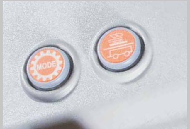
Selezione elettroidraulica della modalità di lavoro (FIELD/TRANSPORT): possibilità di cambiare la modalità FIELD/TRANSPORT a trattore fermo o durante la guida (15 km/h max.).
