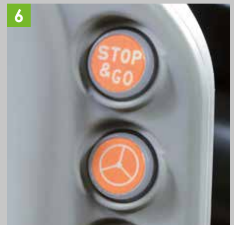
6 Stop&Go e sistema di sterzata rapida SDD.
