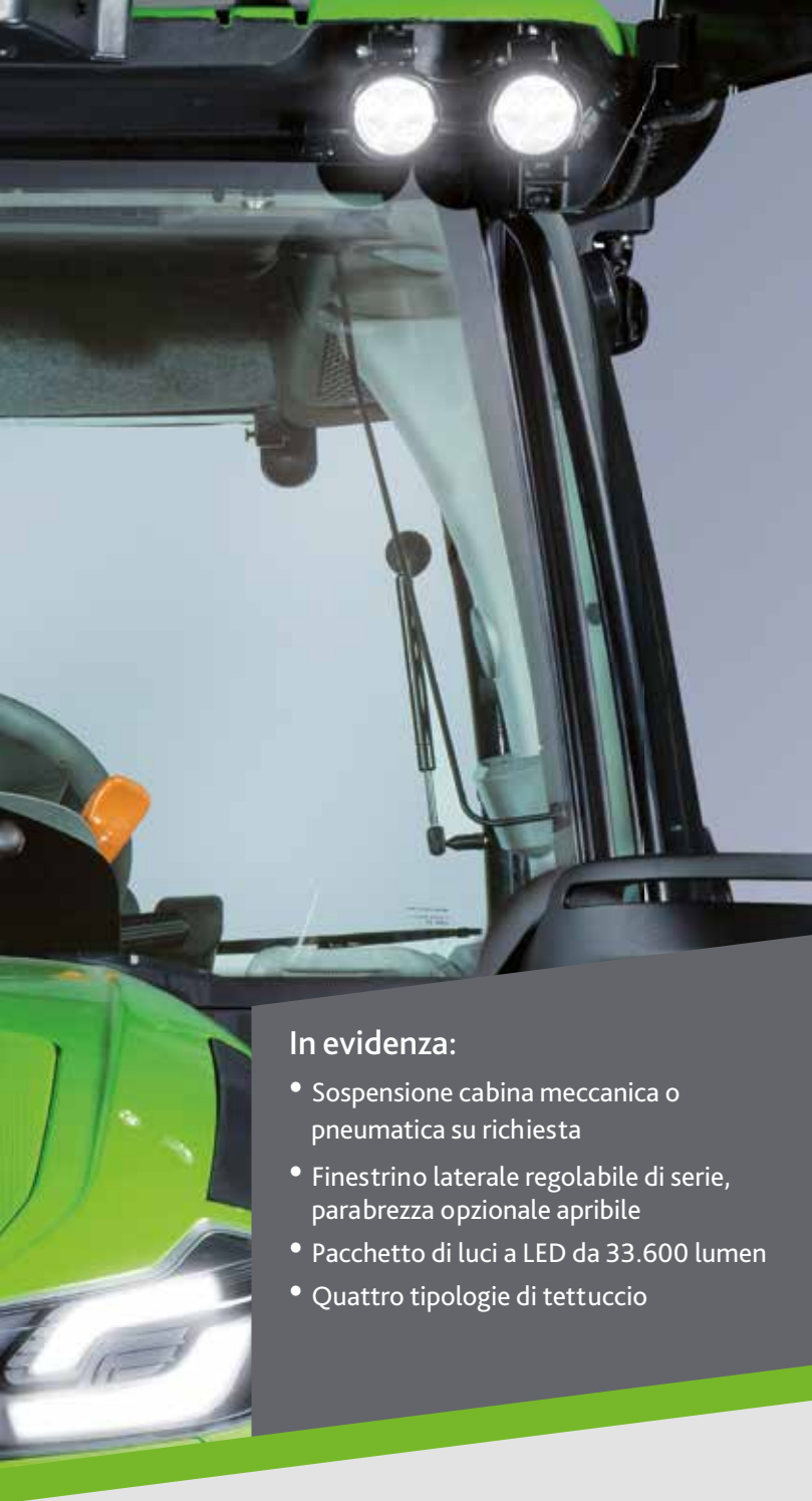
Possibilità di scelta tra quattro diverse tipologie di tettuccio: un tettuccio trasparente, con o senza FOPS e un tettuccio opaco, con o senza FOPS.
