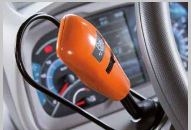
Powershuttle SenseClutch elettroidraulica per inversioni del senso di marcia precise e sicure durante la guida e sotto carico, senza interruzione della coppia.
