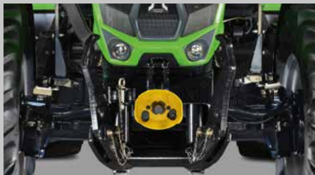
Il potente sollevatore anteriore ha una portata di 2.880 kg. Disponibile anche: il ComfortPack con distributore aggiuntivo anteriore.
