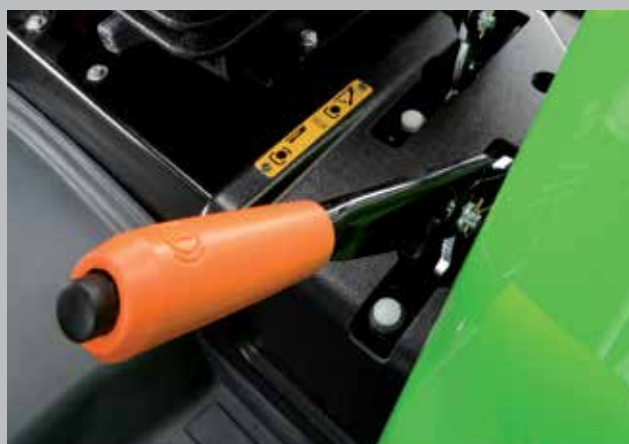
Freno di stazionamento meccanico installato accanto al sedile operatore, a portata di mano.
