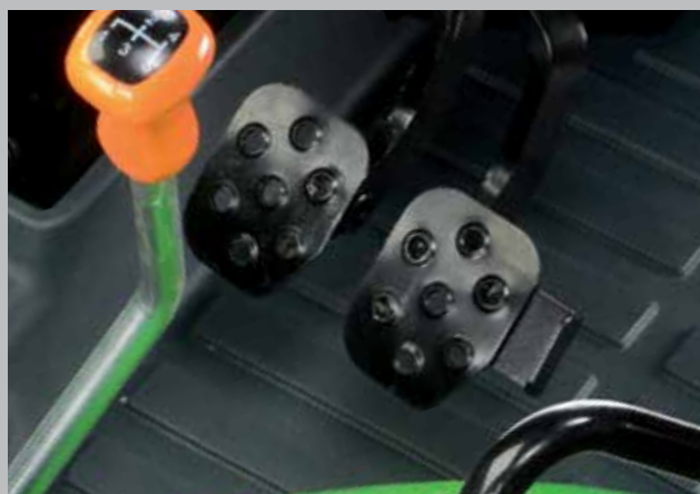
Frenatura su quattro ruote con dischi in bagno d'olio.
