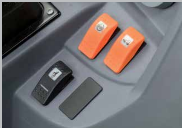
Opzione tra attivazione meccanica o elettroidraulica delle 4 ruote motrici e del bloccaggio del differenziale.
