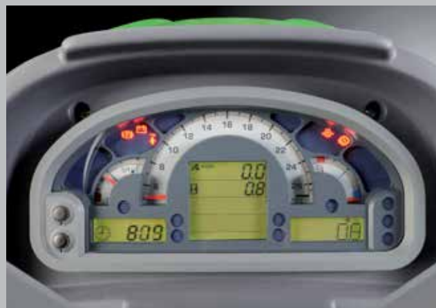
Il nuovo display informativo offre all'operatore una chiara visuale di tutte le condizioni operative, in formato digitale e analogico.
