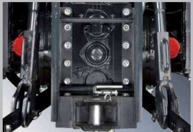
PTO: possibilità di scegliere tra le velocità 540, 540/540ECO, 540/540ECO/1000 o 540/540ECO più PTO sincronizzata.
