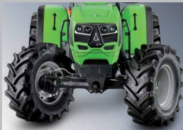
Il cofano compatto consente un angolo di sterzata massimo di 55°.
