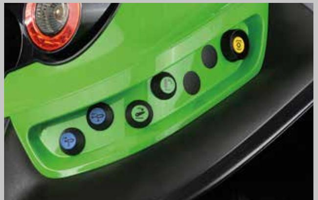
Comando esterno di funzioni idrauliche, sollevatore posteriore e PTO su entrambi i lati.
