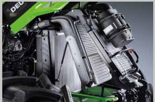
Nuovo sistema di raffreddamento. Apertura completa per semplicità di manutenzione.
