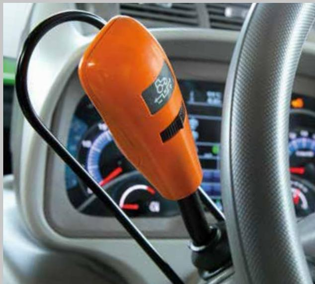
PowerShuttle con SenseClutch, i 5 livelli di sensibilità in retromarcia facilmente regolabili.
