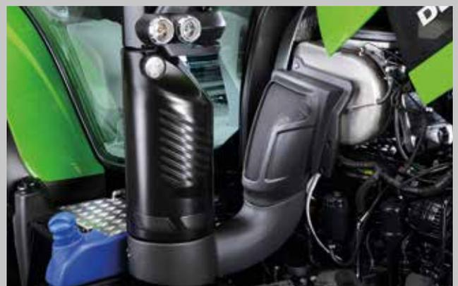
Sistema SCR di post-trattamento gas di scarico e filtro DPF (filtro antiparticolato diesel) passivo per risparmiare su carburante e costi di esercizio.
