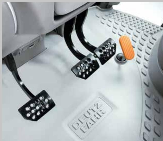
Il sistema di servofreno garantisce elevate prestazioni in frenata applicando poca forza sul pedale.
